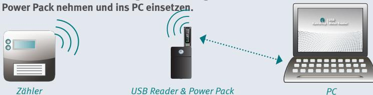
2. Oder Sie können den Zähler über einen USB Reader mit Power Pack auslesen und hiernach die Daten über einen anderen USB Reader, der permanent im PC montiert ist, auf das PC-Programm übertragen.
