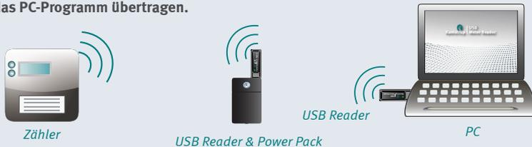
3. Schließlich können Sie in einem Arbeitsgang den Zähler auslesen und die Daten mit einem USB Reader, der direkt in einem Laptop montiert ist, auf das PC-Programm übertragen.
