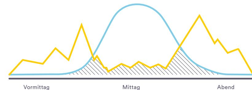
— Strombedarf im Tagesverlauf — Solarstrom Produktion - - - - - Solarstrom Direktverbrauch
